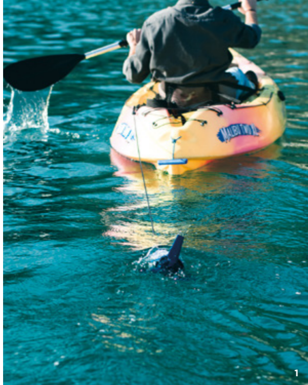
1 휴대용 수력발전기 '우노'는 흐르는 물속에 제품을 설치하는 것만으로 쉽게 전력을 생산할 수 있다. 2 박해린 대표는 2년 전부터 초·중·고·대학에서 신재생에너지 관련 교육을 해오고 있다(코로나19 이전 촬영).
